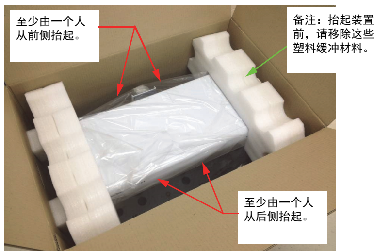
图4 从货箱中取出自动进样器时的抬起位置。
