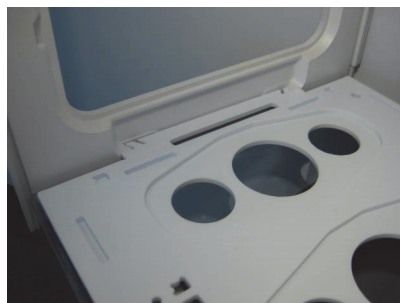
图 7 将管架位置固定垫装在左侧的框架上
