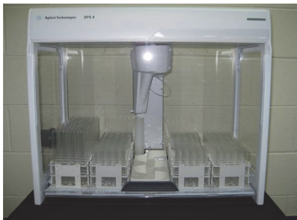
图 12 标准架上装有四个样品瓶架时的样子，在标准溶液架的两侧各有两个。
